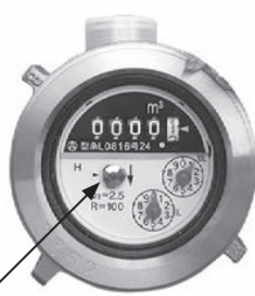
パイロット 水道メーター
