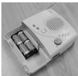
防災無線屋内機
